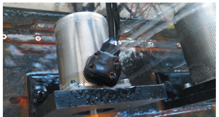
写真3 「CPHBシリーズ」の耐水状況
